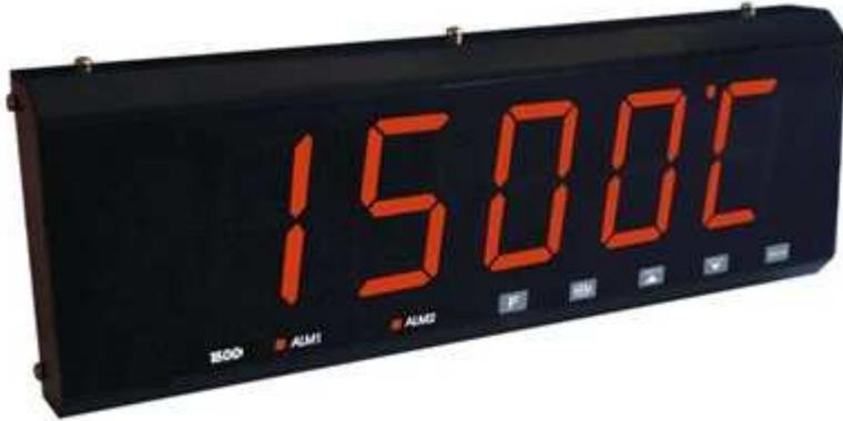
Indicador universal multi-variable con pantalla de 56mm de altura, ideal para visualización a distancia, posee pantalla de 5 dígitos de led, entrada para termopares, RTD Pt100, 4-20 mA, 0-50mV y 0-5 VDC.
