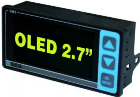
La pantalla SS401 es un indicador con interfaz Modbus para montaje en panel con una pantalla OLED capaz de recolectar los datos de los módulos de medición conectados a este. EL módulo tiene dos puertos seriales RS-485 con comunicación Modbus RTU, el intercambio de datos entre los módulos de medición se realiza a través del puerto RS-485 maestro para poder ser mostrados posteriormente en la pantalla OLED.
